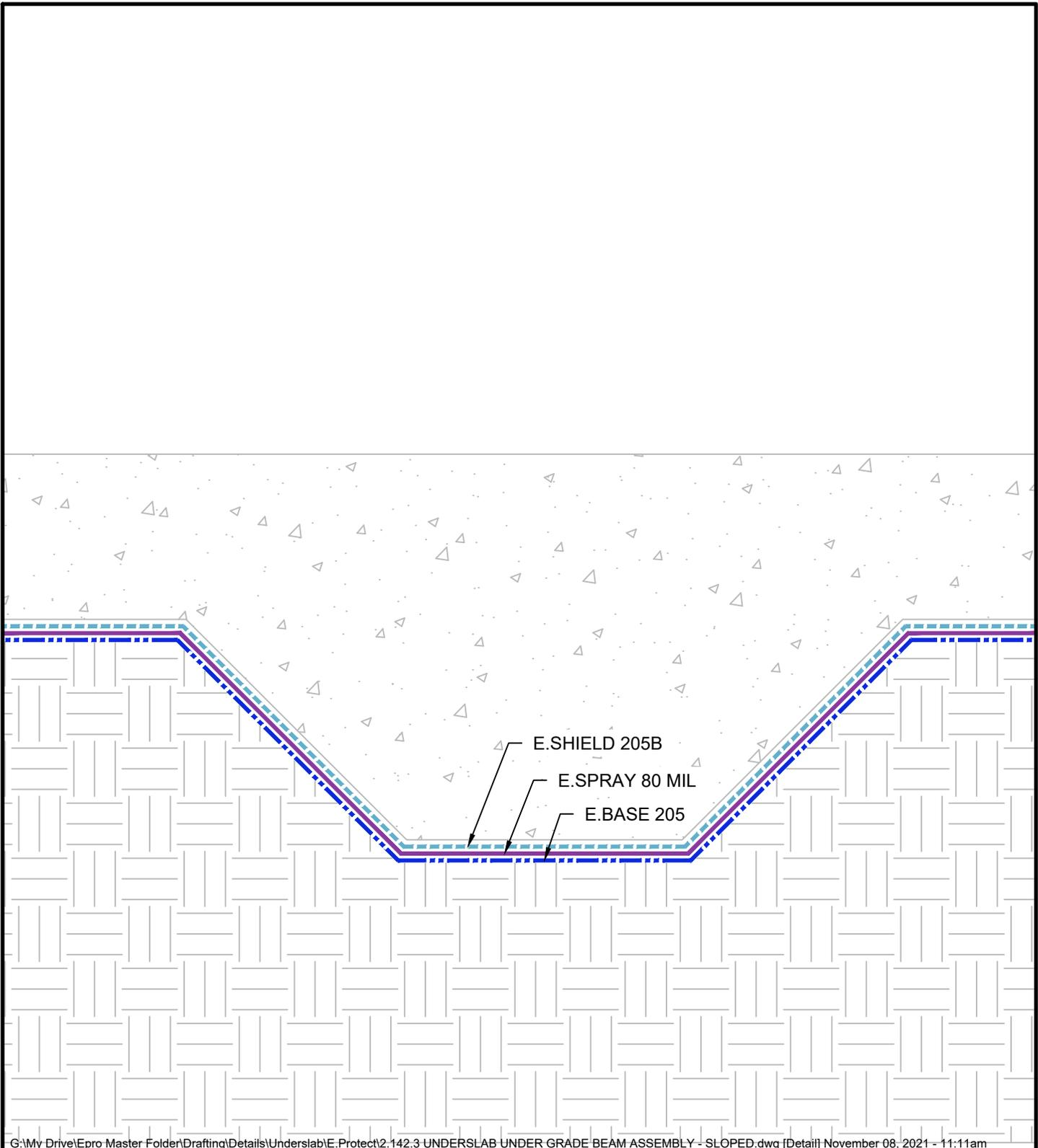
**UNDERSLAB UNDER GRADE BEAM ASSEMBLY - SLOPED**
